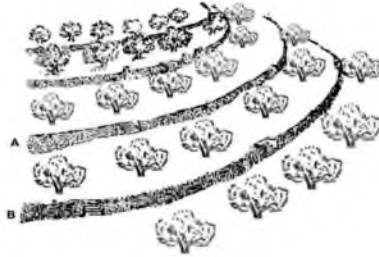
A = Taşlardan yapılmış seki teras B = Kazık ve çalıtlardan yapılmış seki teras
